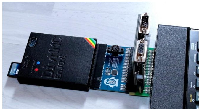
Das PENGUIN zusammen mit dem DIVMMC und dem VGA JOY auf einem Y-Adapter
